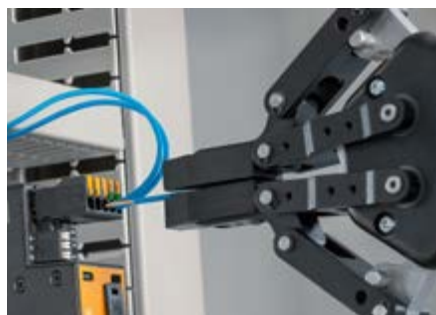
SNAP IN emette un segnale acustico e ottico quando i conduttori vengono inseriti con successo, essenziale per il cablaggio automatizzato di domani
