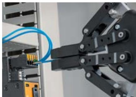
SNAP IN gibt ein akustisches sowie ein optisches Signal bei erfolgreicher Leitereinführung – essenziell für die automatisierte Verdrahtung von morgen
