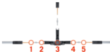
Installation électrique enfichable: au moins 4, souvent 5 points de contact avec pertes de résistance sur la ligne d'alimentation par dérivation.
